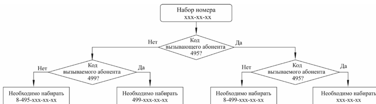
Рисунок П.14.1. Алгоритм набора номера абонента после изменения телефонной нумерации
