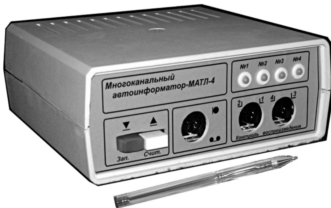
Рисунок П.12.2. Четырёхканальное АИУ с электропитанием посредством АЛ
