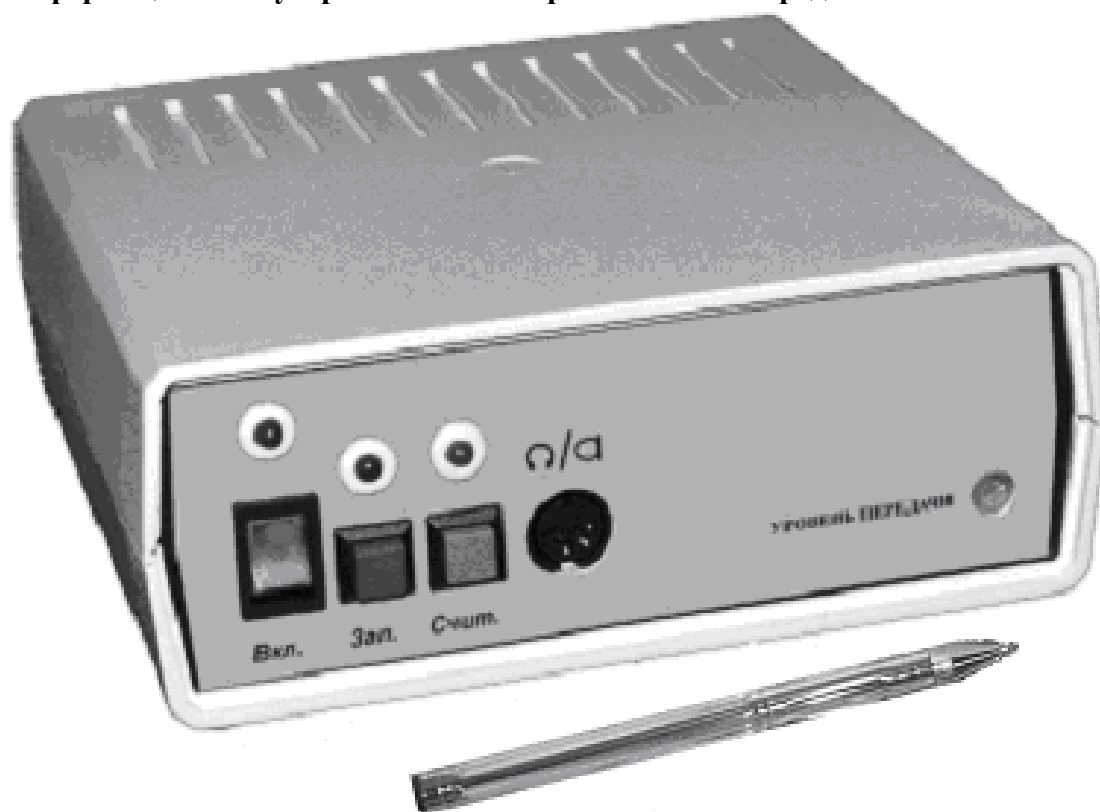
Рисунок П.12.1. Одноканальное АИУ с электропитанием посредством АЛ
