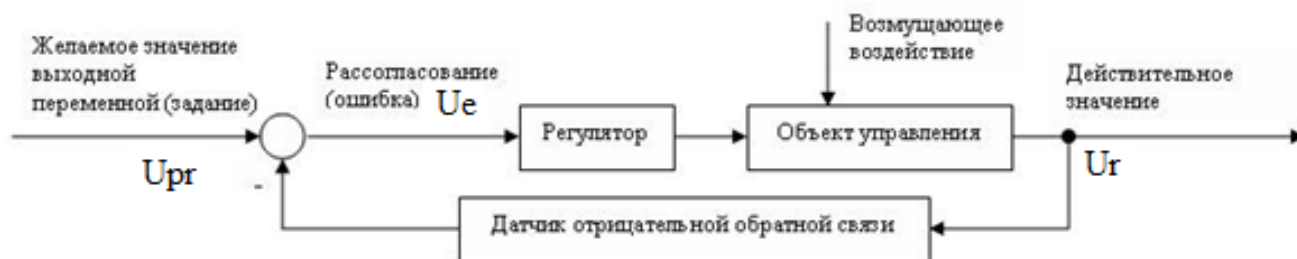
Рис.2. Схема автоматического регулирования с обратной связью
