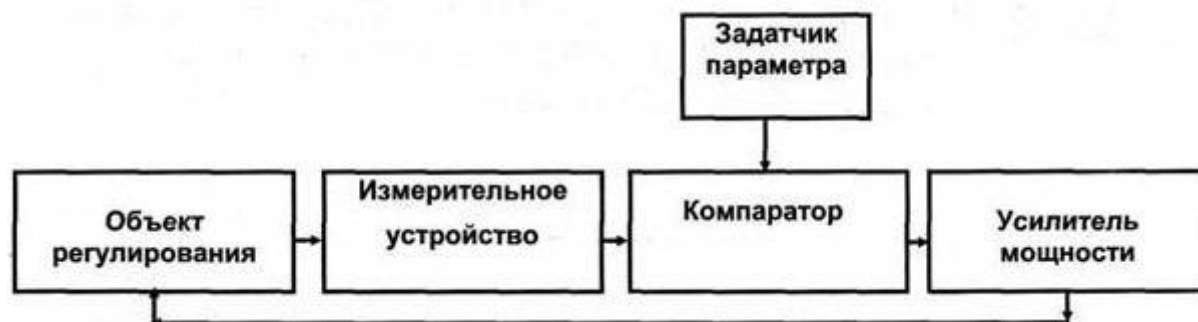
Рис. 1. Функциональная схема регулирования управления
