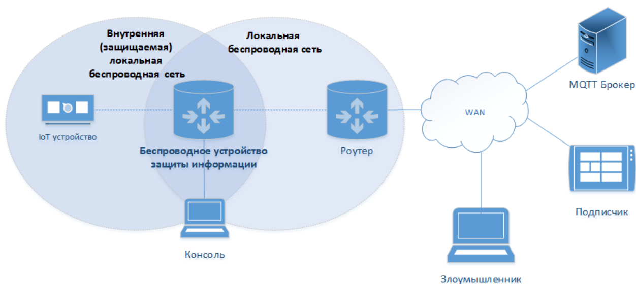
Рис. 2. Защищенная архитектура интернета вещей
