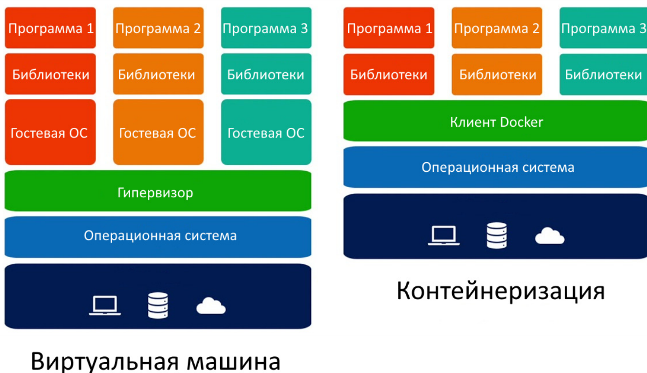
Рис. 1. Архитектура виртуальных машин и контейнеров
