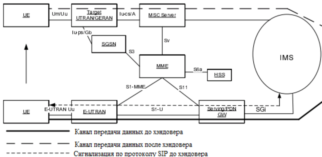
Рис. 7. Схема взаимодействия сети LTE(4G) с PS-доменом сетей 2G/3G в условиях роуминга, терминирования трафика и использования сервисной платформы в гостевой сети 4(4G)
