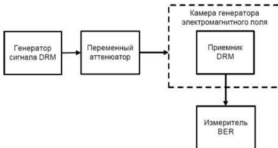
Рисунок ПБ.5 – Схема измерительной установки для измерения чувствительности по напряженности электромагнитного поля
