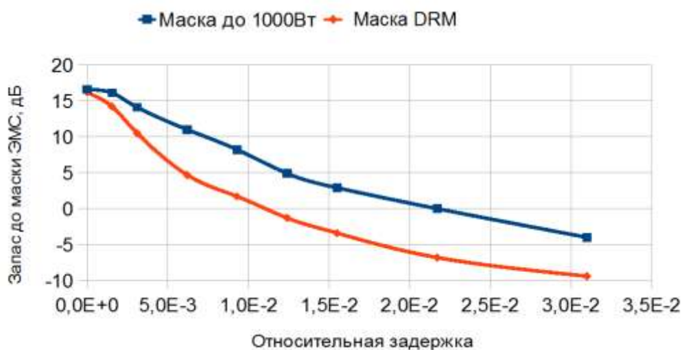
Рисунок 2.12 – Зависимость запаса спектра выходного сигнала до маски ЭМС от нормированной относительной задержки ( \Theta = \tau/T ) между огибающей и ФМ составляющей усиливаемого сигнала
