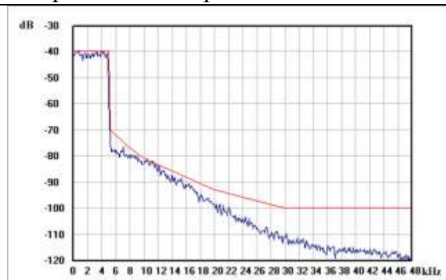
Рисунок 2.9 – Пример спектра выходного сигнала для предельных значений S-образной нелинейности с параметром a = -0,7
