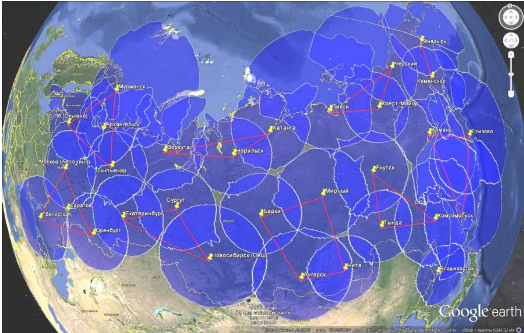
Рисунок 7.17 – Пример архитектуры сети государственного цифрового радиовещания РФ в диапазоне НЧ
