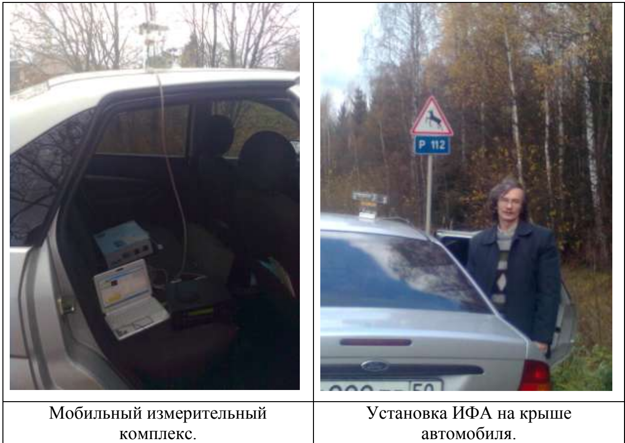
Рисунок 6.13 – Мобильный измерительный комплекс в процессе проведения измерений
