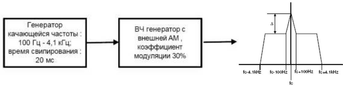
Рисунок ПБ.1 – Генерация АМ сигнала
