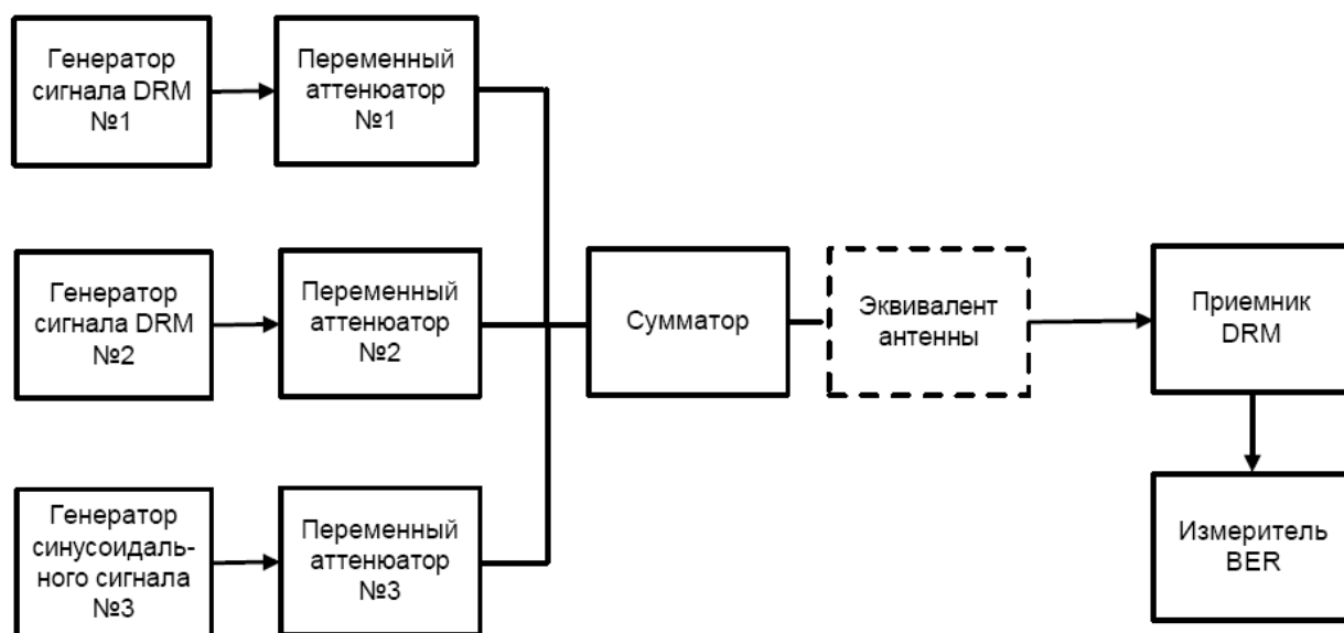
Рисунок ПБ.8 – Схема измерительной установки для измерения величины уровня интермодуляционных искажений
