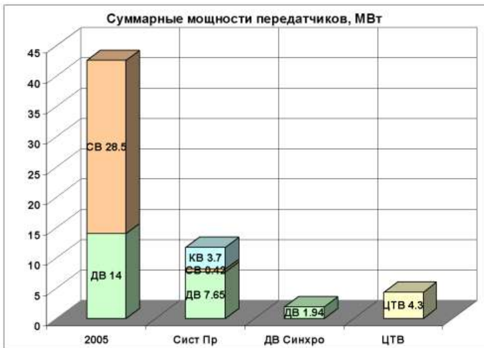
Рисунок 7.19 – Суммарные мощности передатчиков в различных топологиях сетей мощного радиовещания
