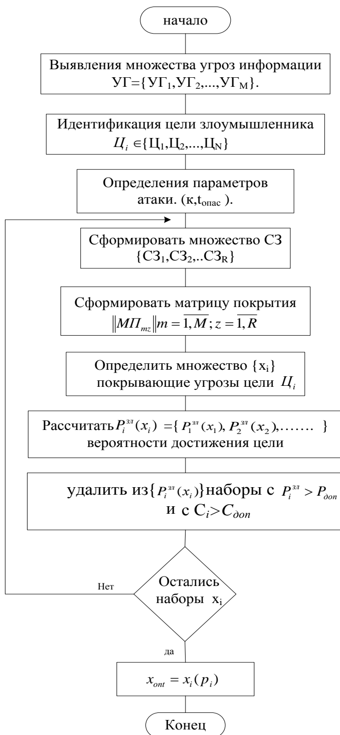
Рис. 5. Схема алгоритма определения состава комплекса средств защиты информации в ИТС
