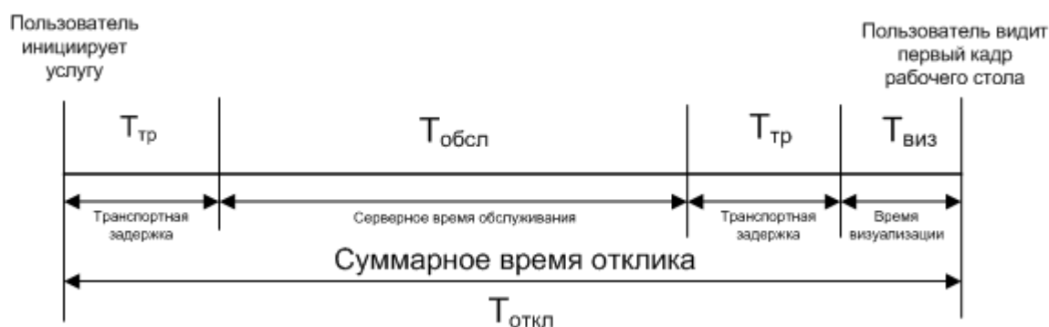
Рис. 2.1. Суммарное время отклика для услуги DaaS согласно рекомендации Y.3503 МСЭ-Т Рассмотрим приведенные на рисунке 2.1 временные интервалы в отдельности.
