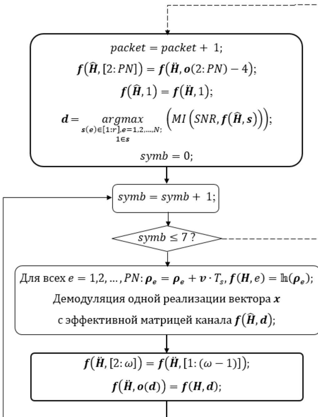
Рисунок 16. Логическая схема для нового метода C1.2+A3.1+ПЗ (см. Приложение 1)
