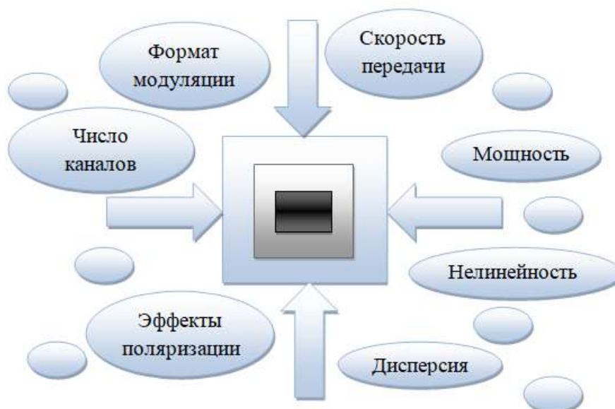
Рисунок 1 – Сжатие окна работоспособности при усложнении систем: 1 – скорость передачи; 2 – формат модуляции; 3 – мощность; 4 – нелинейность; 5 – дисперсия; 6 – эффекты поляризации; 7 – число каналов
