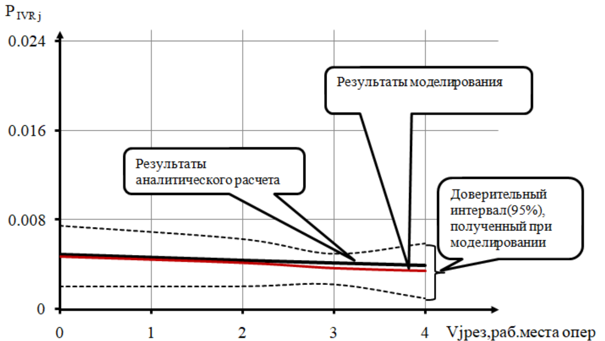
Рисунок 4.9. Результаты аналитических расчетов и моделирования P_{IVR_j} при V_J = 30 [раб.места опер], W = 4 , \lambda_j = 360 выз/час, \lambda_{\text{ЧС}} = 600 выз/час, \mu = 20 [1/ час],
