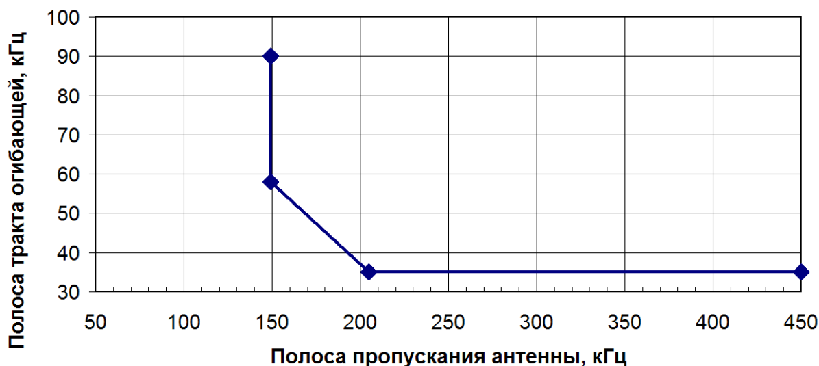
Рисунок 3.19 - Зависимость минимально необходимой полосы пропускания модуляционного тракта от полосы пропускания антенны. ФНЧ двусторонне нагруженный с плавным переходом (от Harris)
