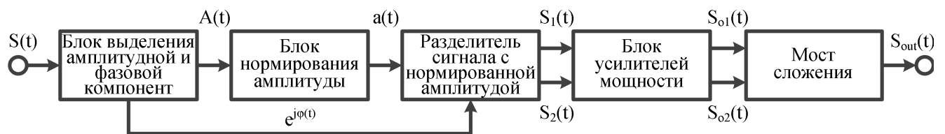
Рисунок 2.10 – Схема преобразования сигнала в усилителе
