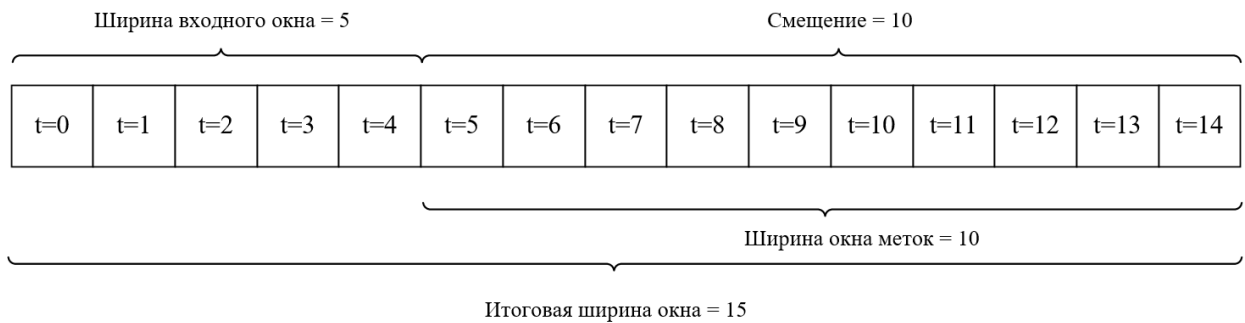
Рисунок 20 – Пример скользящего окна и его характеристик для прогнозирования на 10 шагов вперед, учитывая 5 временных шагов истории
