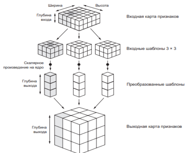
Рис. 7. Принцип работы свёрточного слоя
