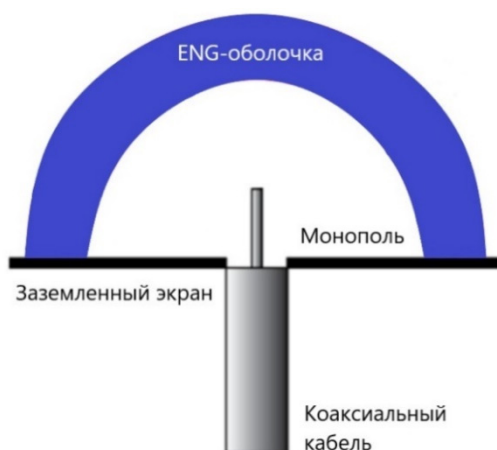
Рис. 3. Метаоболочки в электрически малых антеннах
