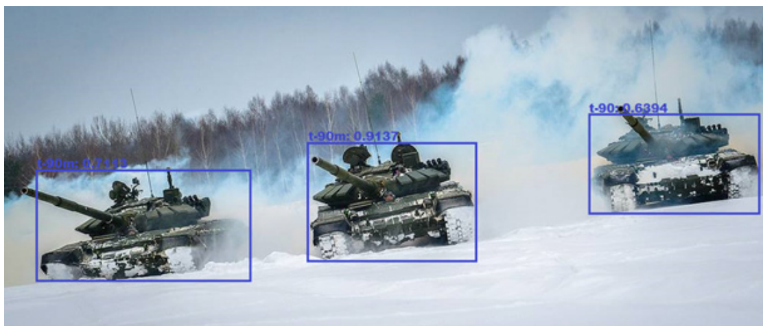
Рис. 5. Обнаружение детектором YOLO танка «Т-90М»
