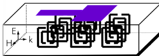
Рис. 1. Печатная антенна с MNG -подложкой
