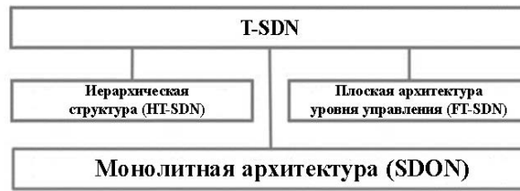
Рис. 2. Классификация решений T-SDN на основе архитектуры плоскости управления
