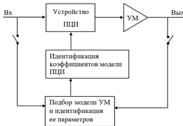
Рис. 2. Блок-схема УМ с устройством предварительного цифрового искажения
