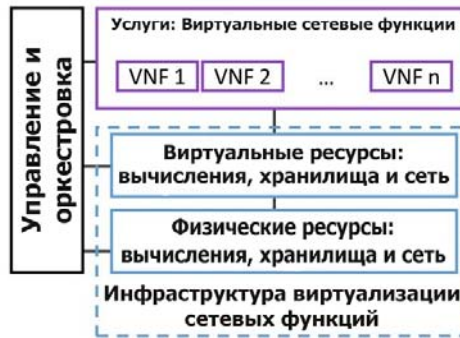
Рис. 4. Архитектура виртуализации сетевых функций
