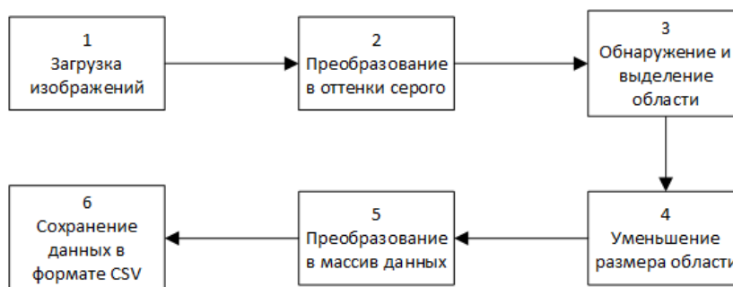
Рис. 4. Алгоритм подготовки обучающего набора данных
