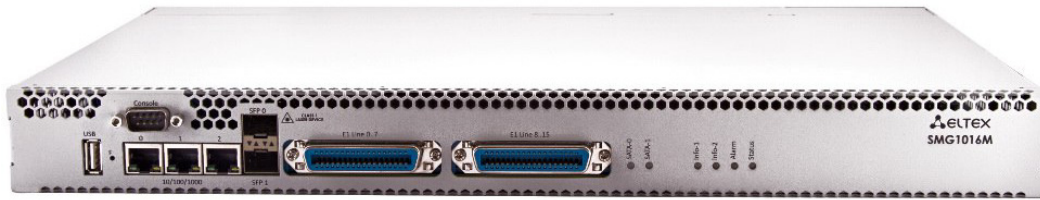
Рис. 5. Транковый шлюз SMG-1016M
