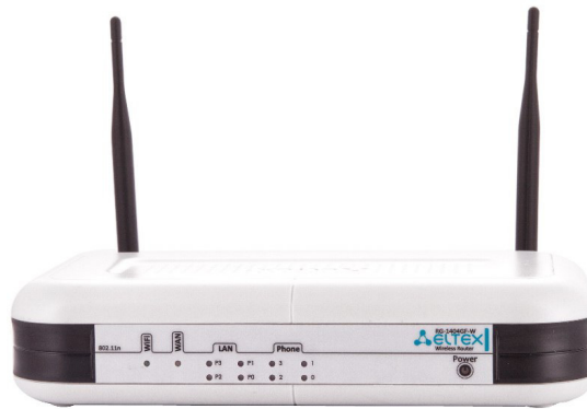
Рис. 6. Абонентский маршрутизатор RG-2402G-W
