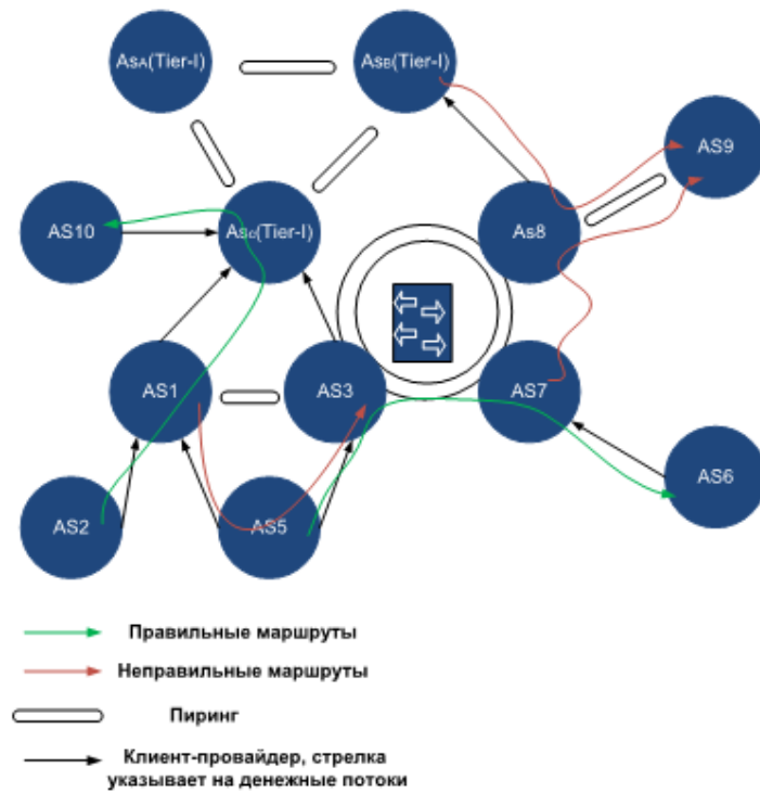
Рис. 3. Структурная схема процесса маршрутизации между автономными системами
