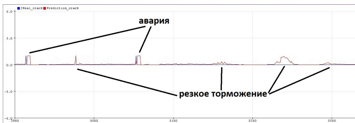
Рис. 8. График изменения предсказывающей аварии при столкновениях и резких торможениях
