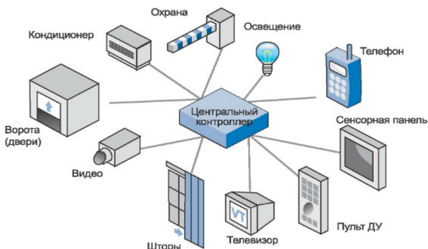
Рис. 1. Функциональные элементы системы домашней автоматизации
