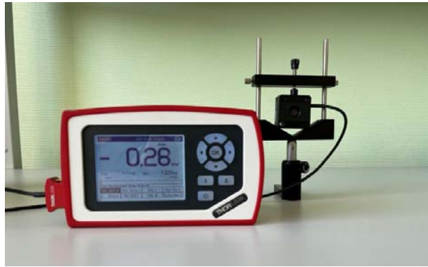
Рис. 5. Измеритель мощности Thorlabs PM100D и термический датчик Thorlabs S405C
