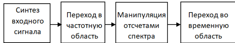
Рис.4. Структурная схема алгоритма преобразования частоты дискретизации в частотной области
