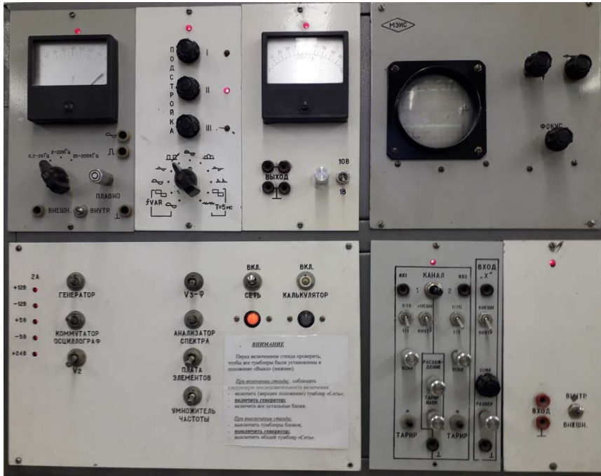
Рис. 1. Блоки лабораторного стенда ЛКТЦ для проведения экспериментов по теме «Спектральный анализ»
