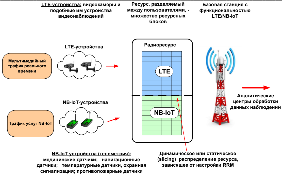
Рис. 1. Функциональная модель формирования входного потока данных IoT в сети оператора систем наблюдений
