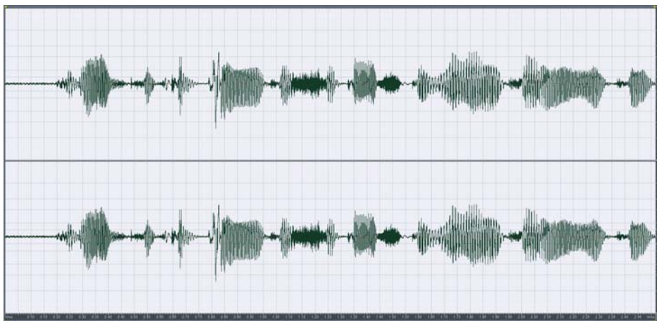
Рис. 7. Исходный сигнал (сверху) и сигнал после 4-х этапов передискретизации
