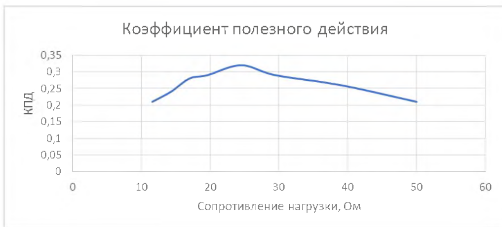
Рис. 7. Зависимость КПД усилителя от сопротивления нагрузки
