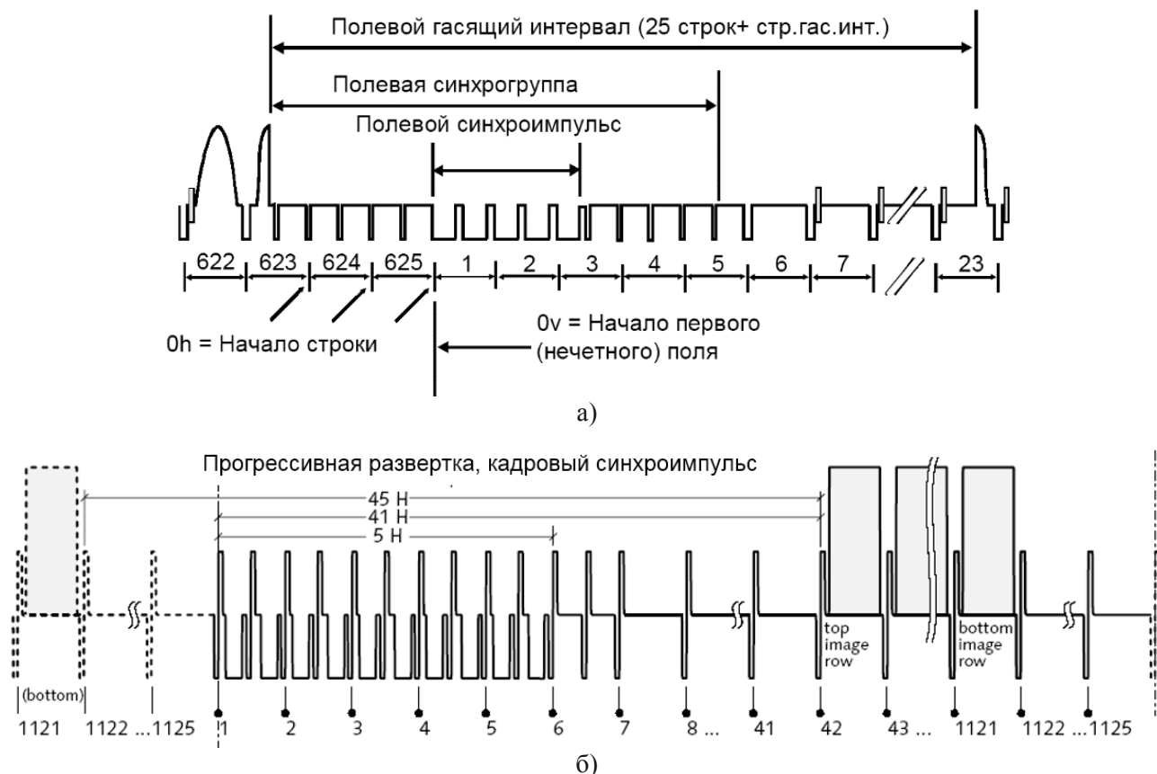
Рис. 2. Форма сигналов синхронизации: а) черного поля (black burst), б) трехуровневой
