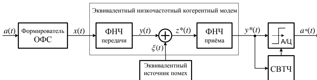
Рис. 2. Низкочастотная эквивалентная модель когерентного модема
