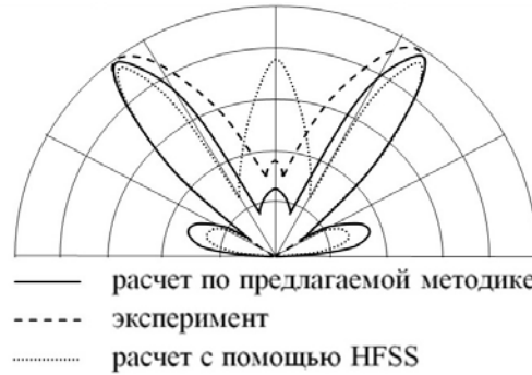
Рис. 3. Диаграммы направленности полуволновой линейной щели с диэлектрическим покрытием в плоскости Н
