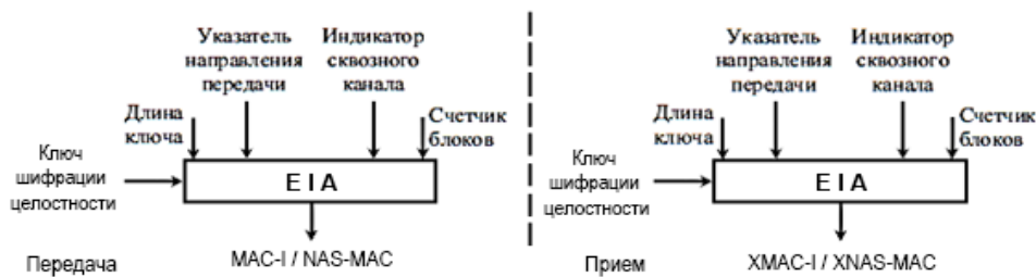
Рис. 8. Алгоритм проверки целостности в E-UTRAN
