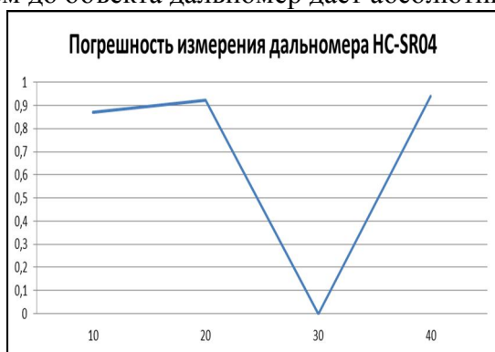
Рис. 5 – Погрешность измерения дальномера HC-SR04
