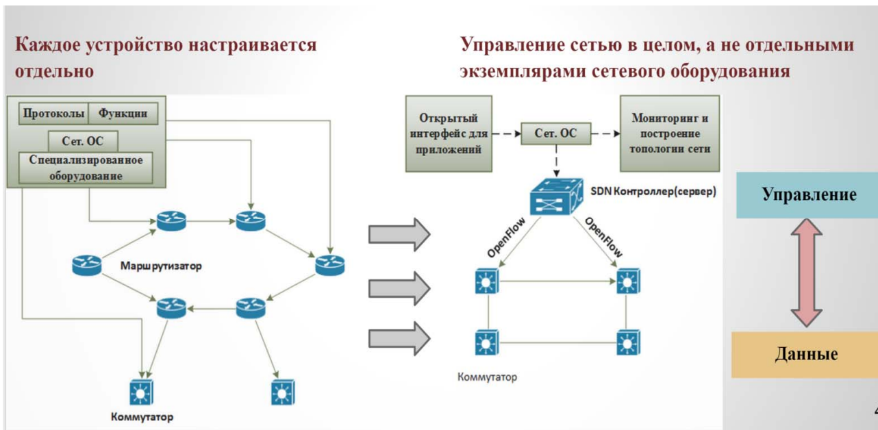
Рис. 1. Сравнение архитектуры традиционных сетей и сетей SDN
