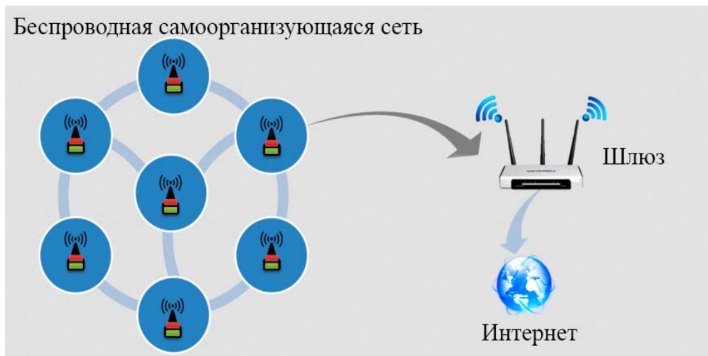
Рис. 3. Схематическая топология Интернета вещей
